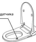
Проверяя функции очистки, сушки и дезодорации, убедитесь, что датчик включен. При очистке закрывайте распылительную форсунку, чтобы не допустить разбрызгивания воды.
